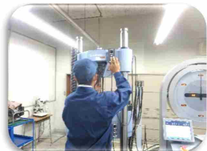
試験材料を試験機にセットします
