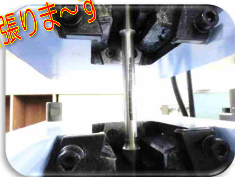
試験材料を試験機にセットします
